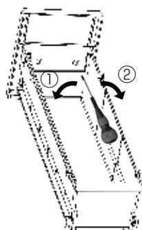
①ねじをゆるめて鏡板を調整します。
