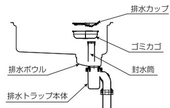
〈封水筒の取付け・取外し〉
