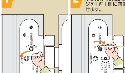
2 ドア本体を枠外側に動かすために前後調整ネジを「前」側に回転させます。
