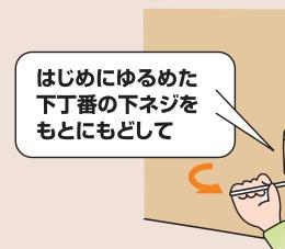
5 下丁番の上部調整ネジを、上から見て時計回りに回転させ、しっかりと締めつけ、固定します。
