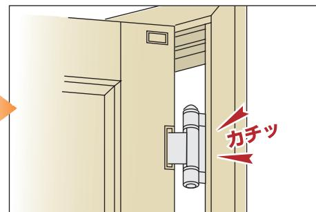
4 カチッと音がし、固定されたら吊り込み完了です。
